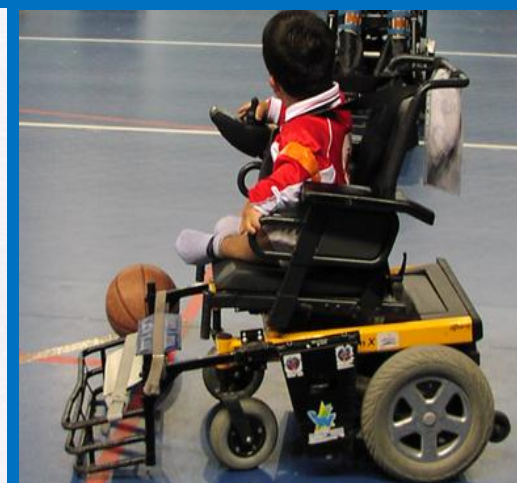
2) Fauteuil électrique équipé d'un pare-choc pour la pratique du foot-fauteuil.
